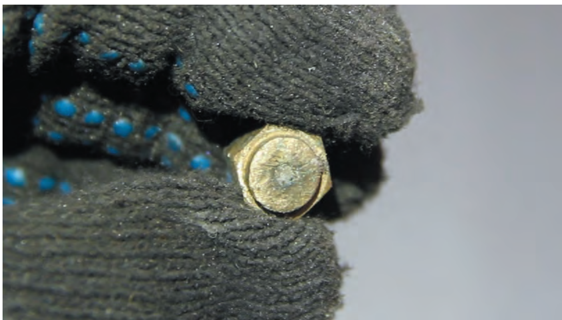
Рис. 3. Забитое сопло спустя день простоя
