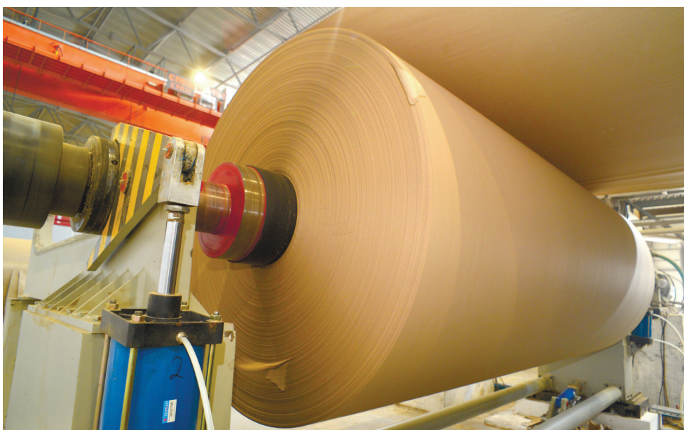
Рис. 2. Переработка макулатуры, позволяющая использовать до 60 % низкосортного сырья
