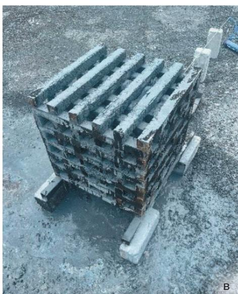
Рис. 1. Огневые испытания реагента FLAMS на модельном очаге: а) подготовка к испытаниям; б) во время испытаний; в) результат испытаний
