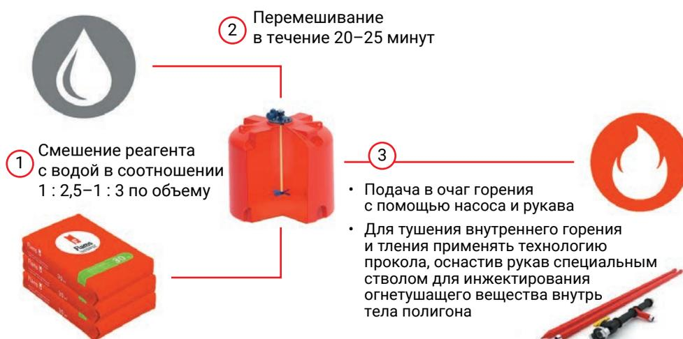
Рис. 3. Технология приготовления и применения огнетушащих веществ из реагентов FLAMS и FLAMS GEL
