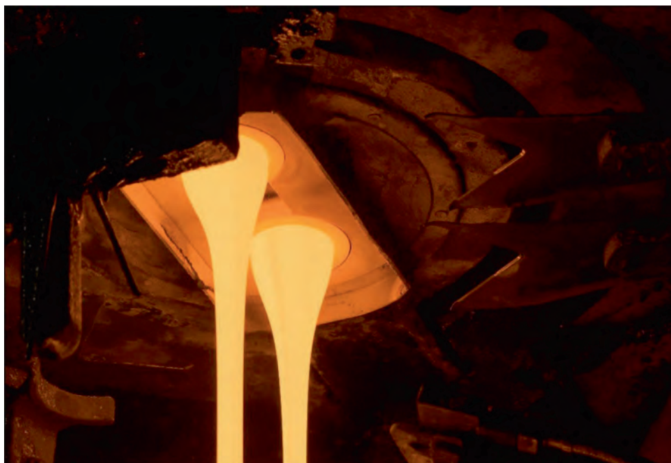
Рис. 2. Подача стекломассы в процессе стекловарения
