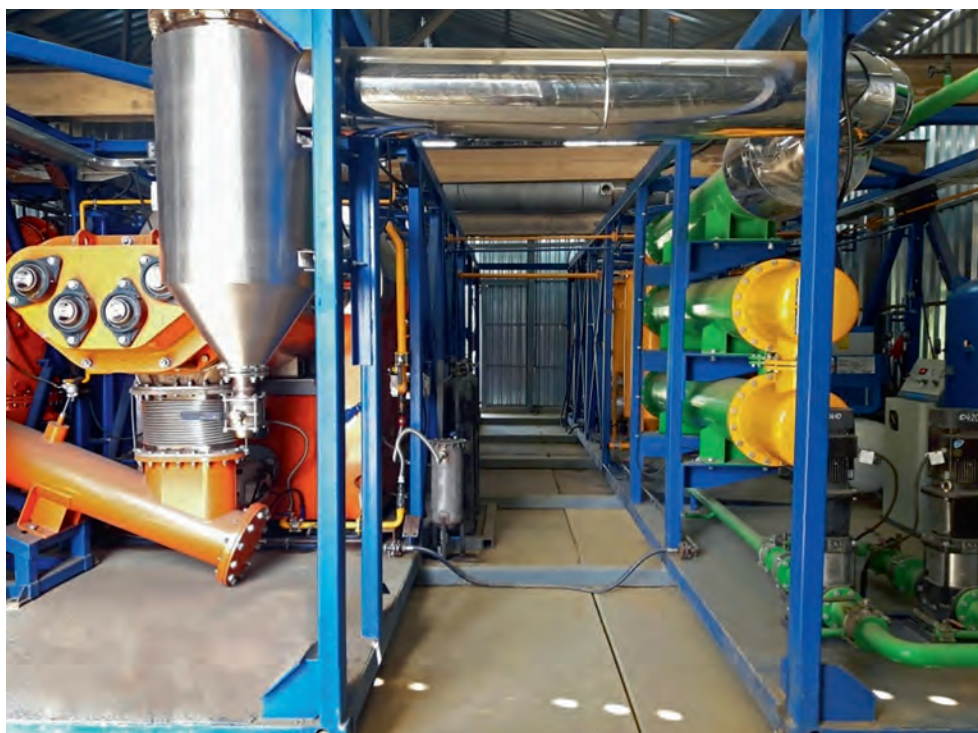
Рис. 2. Технологическая обвязка установки утилизации отходов бурения УТД-2
