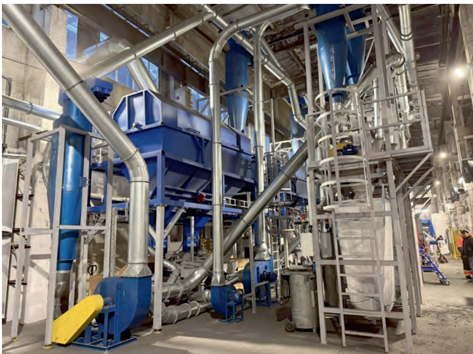
Рис. 2. Производственная линия утилизации шин
